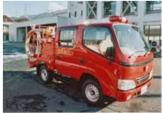
【写真：消防団に配備される小型動力ポンプ積載車】
